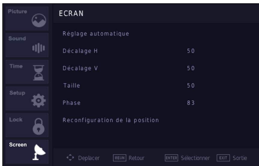
1. Appuyer sur les touches « ▲/▼ » pour sélectionner « Auto Adjust » (Réglage automatique) et appuyer sur « ENTER » (ENTRER) pour régler le paramètre.
